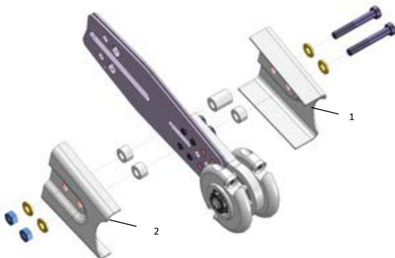
Fig. 8. Montaggio delle piastre di protezione
