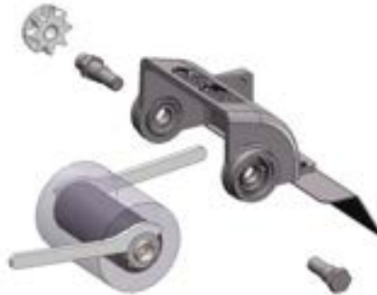
Fig. 15: Cambio della spazzola rotante
