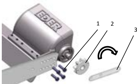
2. sz. ábra: A kéregzőfej rögzítése a tartóra
