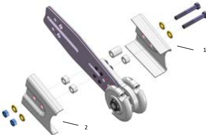
Abb. 8. Montage der Schutzbleche
