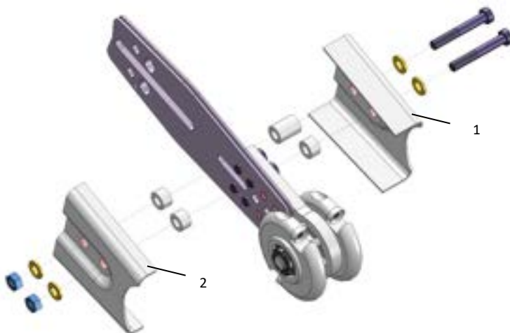
Fig. 8. Montage des tôles de protection
