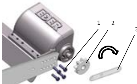
Fig. 2: Fissaggio della testa di scortecciatura al supporto
