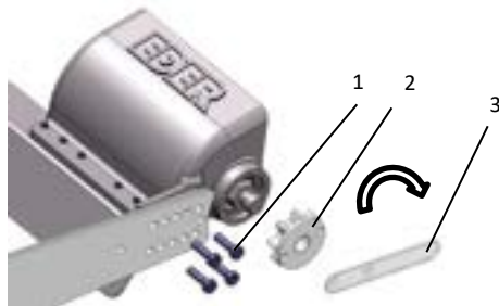
Abb. 2: Befestigung des Schälkopfes am Träger
