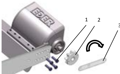
Fig. 2 : Fixation de la tête d'écorçage sur le support
