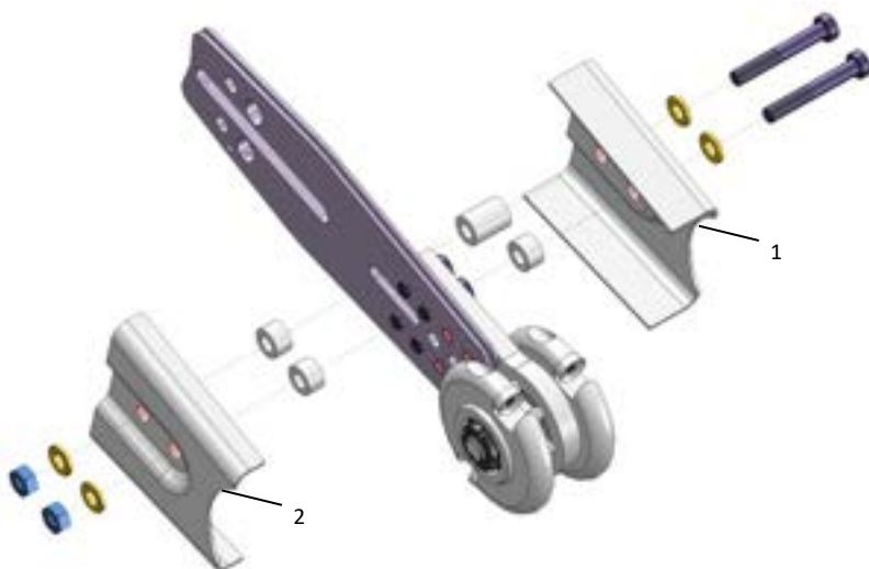
Obr. 8. Montáž ochranných plechov
