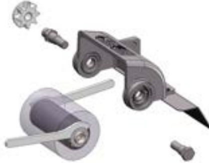
Fig. 15 : Remplacement de la brosse rotative
