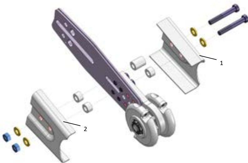
8. ábra: A védőlemezek felszerelése
