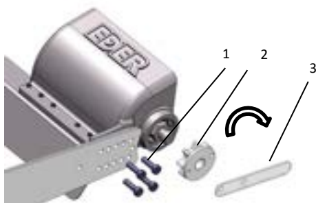
Obr. 2: Upevnění hlavy odkorňovače na držák
