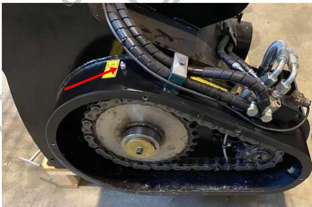
Abbildung 10-2: Beispieldarstellung Schmierstelle Welle links
