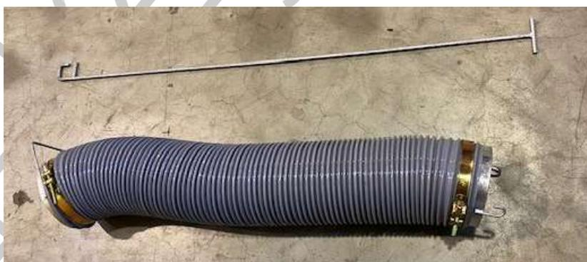
**Abbildung 7-7: Entladerohr mit Führungsstange**
