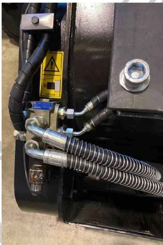
Abbildung 4-1: Beispieldarstellung Magnetventil
