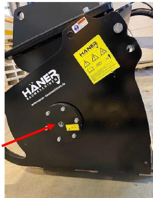
Abbildung 10-1: Beispieldarstellung Schmierstelle Welle rechts
