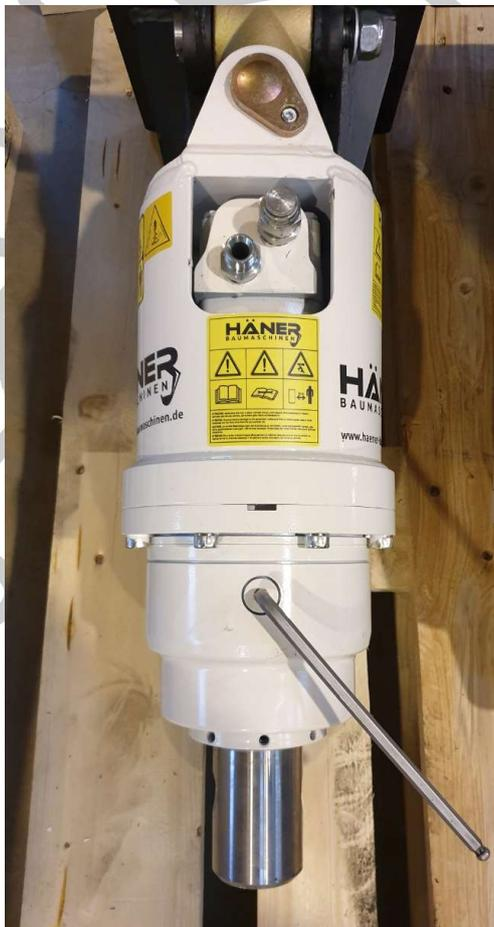
**Abb. 9: Ölschraube lösen**
