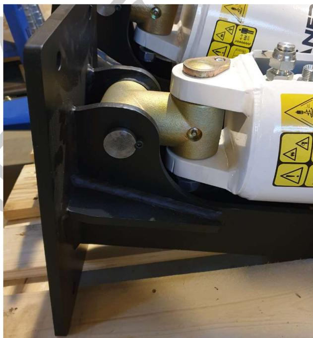
Abb. 2: Adapterrahmen Erdbohrer
