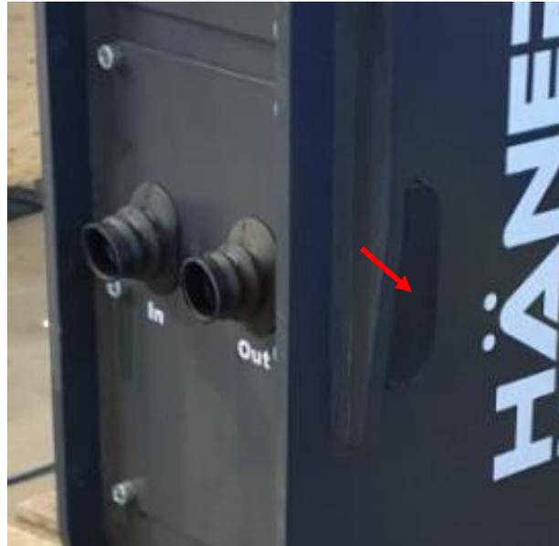
Abb. 21: seitliche Stopfen entfernen
