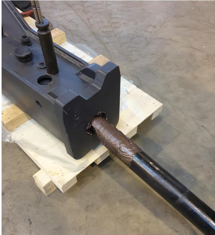
**Abb. 9: Meißel entfernen und wechseln**
