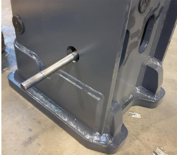
**Abb. 14: Befestigungsbolzen entfernen**
