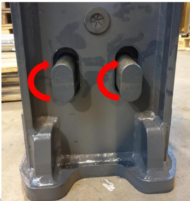
**Abb. 16: Sicherungsbolzen wenden**
