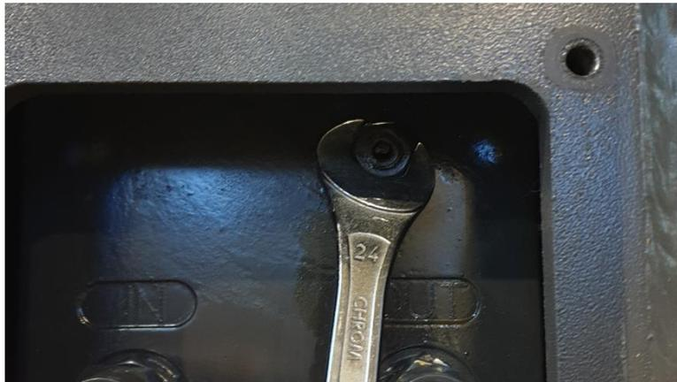
**Abb. 19: Mutter lösen**
