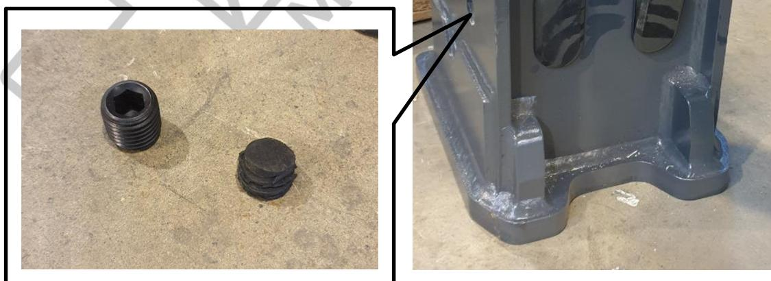
**Abb. 13: Madenschraube und/oder Stopfen entfernen**
