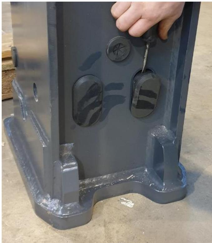
**Abb. 12: vorderen Stopfen entfernen**
