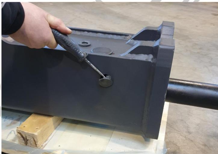
Abb. 5: seitliche Stopfen entfernen
