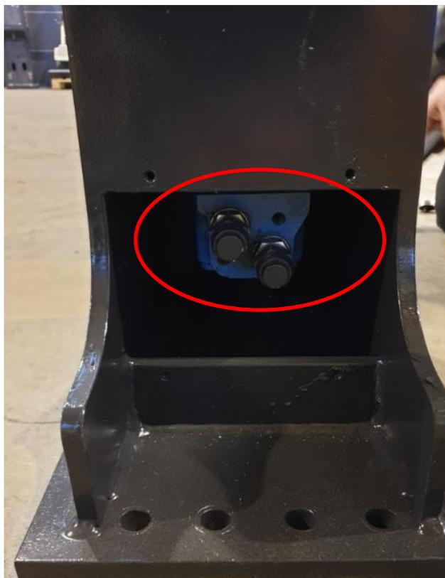
Abb. 2: Hydraulikanschlüsse Kegelspalter
