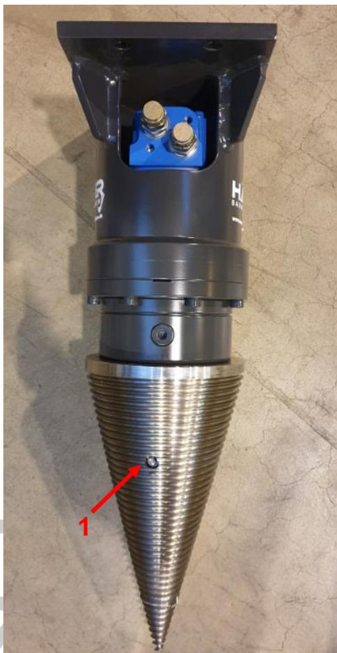
Abb. 3: Einbau / Wechsel Drillkegel
