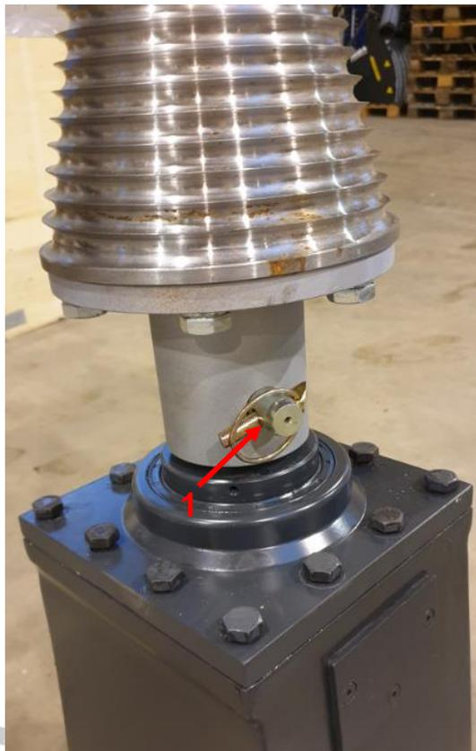
**Abb. 4: Einbau / Wechsel Drillkegel**
